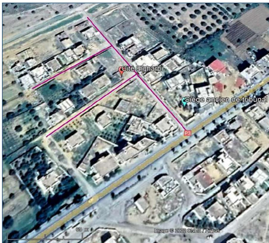
Figure 5 : Voies projetées pour l'extension du réseau d'assainissement à la cité El Gharbi.
