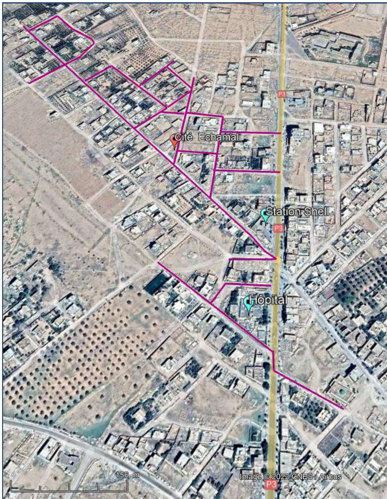
Figure 3 : Voies projetées pour l'extension du réseau d'assainissement à la cité Echamali-route.
