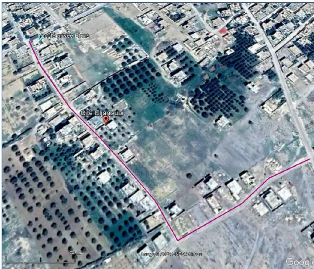
Figure 4 : Voies projetées pour l'extension du réseau d'assainissement à la cité Eljanoubi.
