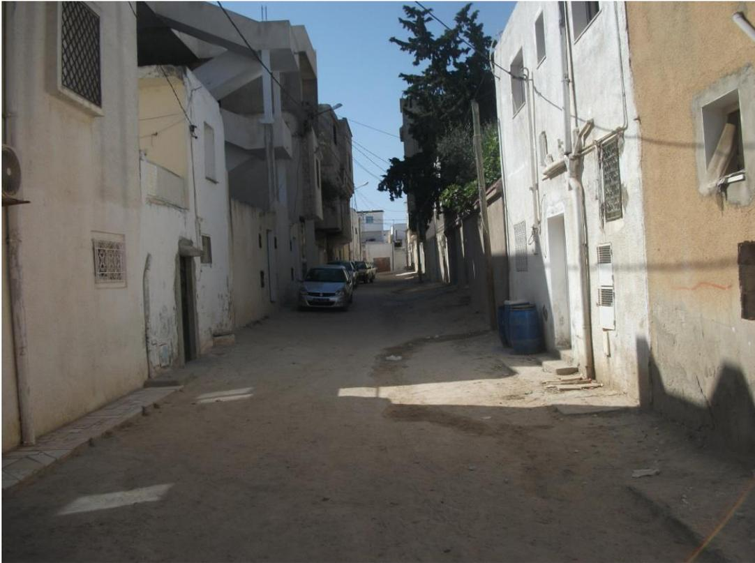
**Figure 7: Largeur de l'impasse assez constante, de l'ordre de 5m et visuellement ne contenant pas d'obstacle qui gênera l'exécution d'un réseau de drainage des eaux pluviales.**
