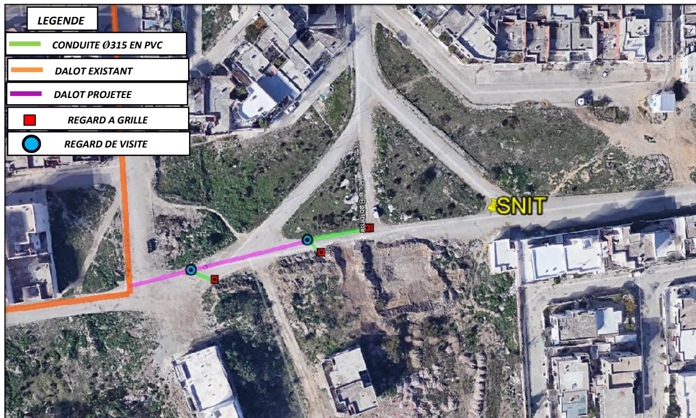
Plan d'intervention Réseau eaux pluviales : Rue SNIT
