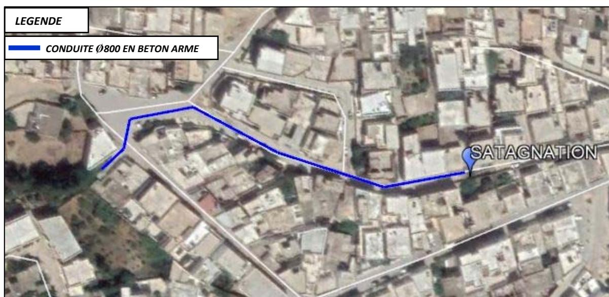
Plan d'intervention Réseau eaux pluviales : Sanit El Beb
