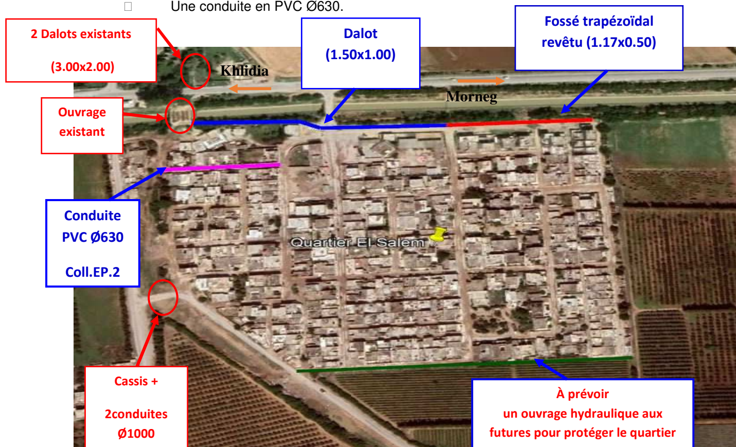
Figure 3: Canal extérieur projeté d'évacuation des eaux pluviales
