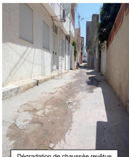
Dégradation de chaussée revêtue en béton armé, stagnation des eaux usées et présence des points lumineux. (Voie N°7)
