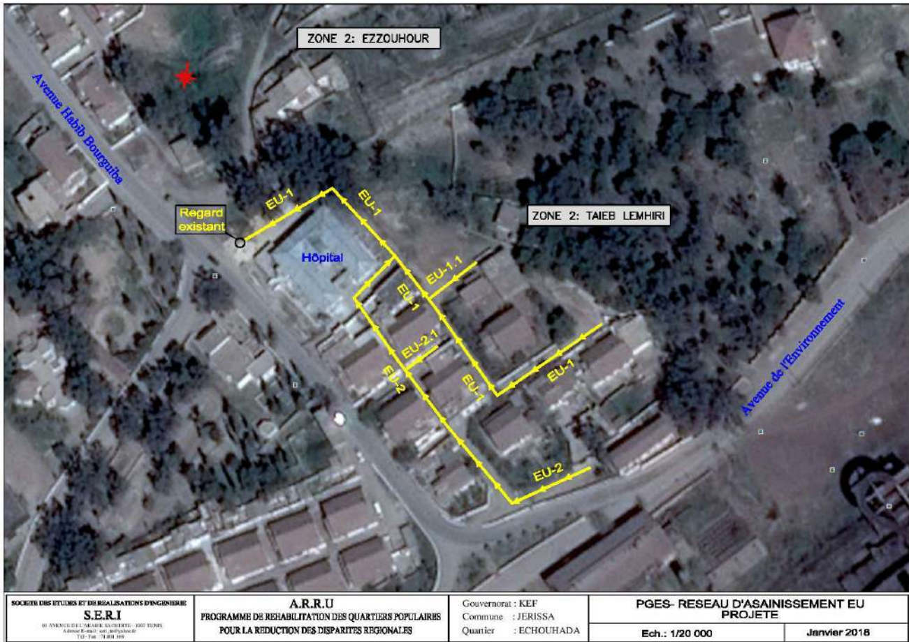
Figure 10: Réseau d'assainissement EU projeté (Zone 2-Taieb Lemhiri)
